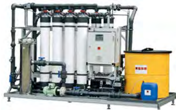
Große Mikrofiltrationsanlage MF20 mit einer Leistung von 20 m³/h. Eine SPS-Steuerung sorgt für einen automatischen Betrieb. Sobald die Filtrationsleistung unter ein Minimum abfällt, werden die Membranen mit Filtrat rückgespült. Mit dem gelben CIP-Tank können die Mikrofiltrationsmembranen chemisch gereinigt werden; auch eine Desinfektion ist möglich. Das SPS-Programm führt schrittweise durch die Reinigungsprozedur. Foto: AquaCare
