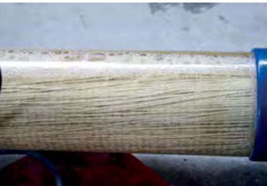
Hohlfasermodul mit transparentem Gehäuse während der chemischen Reinigung mit Säure. Deutlich sind die einzelnen Hohlfasern – in diesem Beispiel 650 Stück - zu erkennen. Foto: AquaCare
