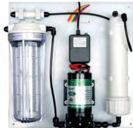
Kleine Mikrofiltrationsanlage MF0020 mit Vorfilter, Wickelmodul und Pumpe. Die Leistung beträgt bis 40 l/h. Foto: AquaCare
