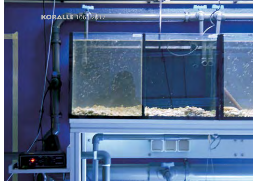
Experiment zur Veranschaulichung der Filtrationsleistung einer Mikrofiltrationsanlage. Die Aquarien links und rechts wurden mit normalem Wasser aus dem zentralen Aquariumfilterkreislauf versorgt, das Aquarium in der Mitte mit mikrofiltriertem Wasser aus demselben Kreislauf. Dass Partikel entfernt werden, hat hier zu geringerem Bewuchs von filtrierenden Organismen auf der Scheibe geführt. Auch Trübungen durch Reinigungsarbeiten im restlichen System gelangen nicht in das mittlere Aquarium. Foto: AquaCare
