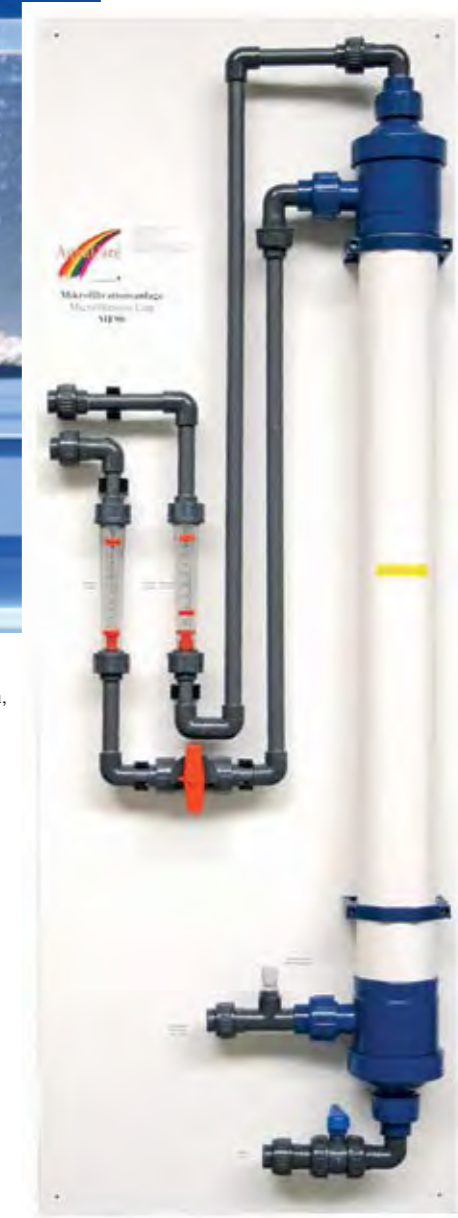
Mikrofiltrationsmodul MF090-100 mit Hohlfasermodul und Durchflussmessern. Die Leistung beträgt bei 2 bar Druck ca. 1.000 l/h. Foto: AquaCare.
