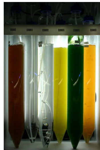
Algenröhren von mindestens 4 Litern Inhalt sind die Mindestgröße um vernünftig Algen anziehen zu können. Foto: AquaCare
