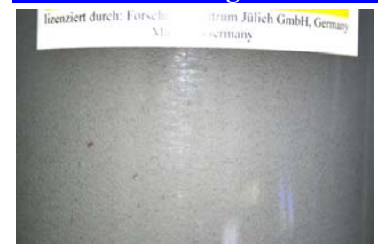
Blasen sollten einen Durchmesser von unter 1 mm haben, um eine große Oberfläche zu erzeugen. Foto: AquaCare ACF3000V-170 mit Injektor bei 35‰ Salzgehalt, 15°C, eingefahrenes Riffaquariumwasser, Blasengröße: durchschnittlich kleiner 0,7 mm
