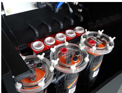
Mehrere Filtersocken bei einem größeren System mit jeweils zugehörigem Zulauf
