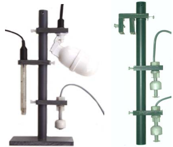
Bodenhalter mit Schwimmerschalter (rechts unten), pH-Messkette (links) und Schwimmerventil (rechts oben) Scheibenhalter mit zwei Schwimmerschaltern (rechts)
